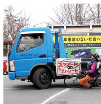
内輪差による巻き込み事故の再現
